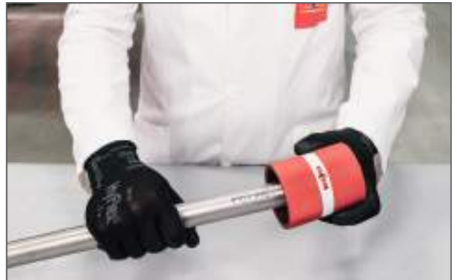
Sbavatura del tubo / Deburring the pipe
