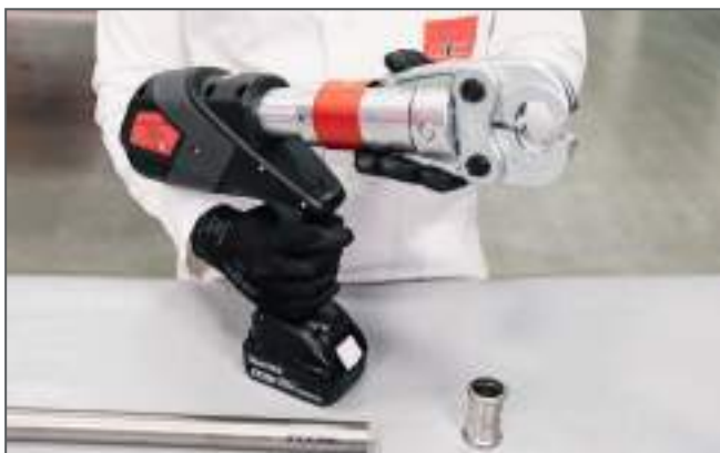
Preparazione della macchina pressatrice / Press machine preparation
